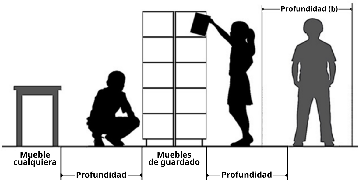
Ilustración 5 - Separaciones mínimas para muebles de guardado
